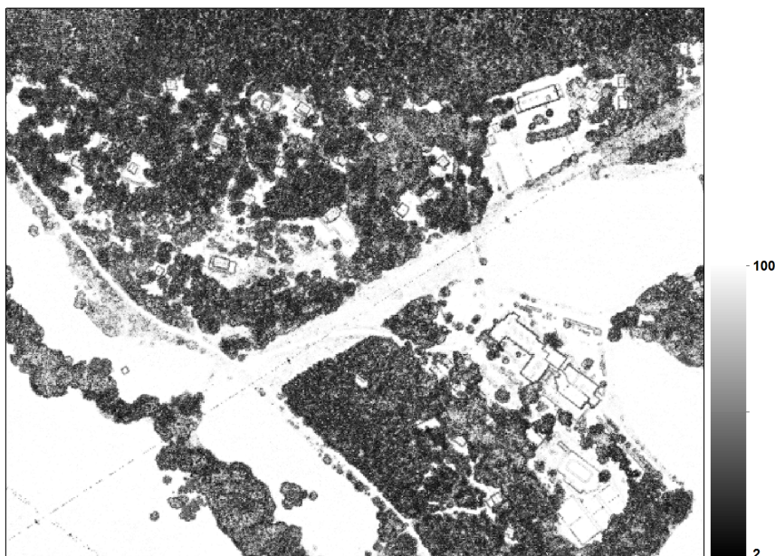
Obr. 2. Hodnoty Počítania odrazov, na obrázku je možné rozlíšiť nepriepustné povrchy pre laserové impulzy (biele) a priepustné povrchy pre laserové impulzy (tmavé).
