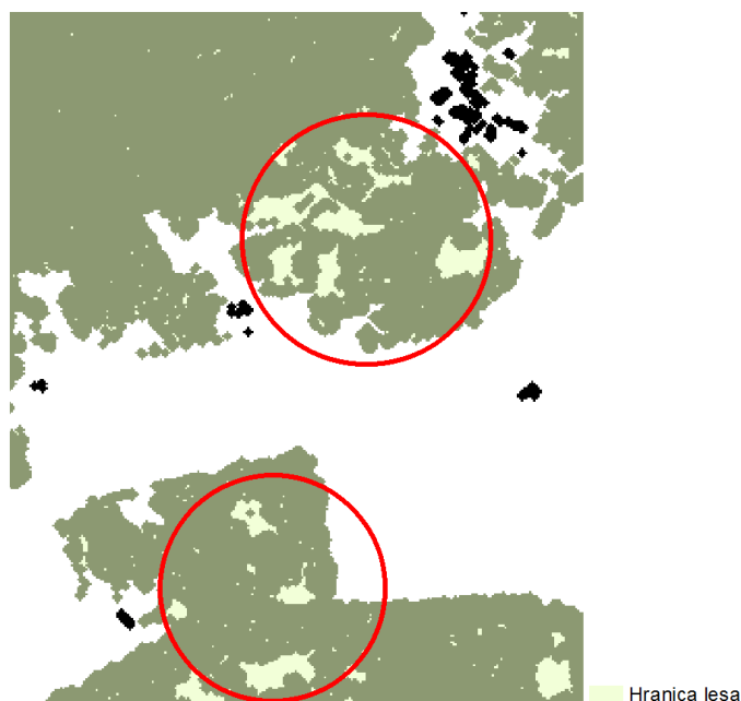
Obr. 5. Diery vo vegetácii po aplikácii morfológického filtra „erode“, ktoré boli zahrnuté do polygónu reprezentujúceho les
