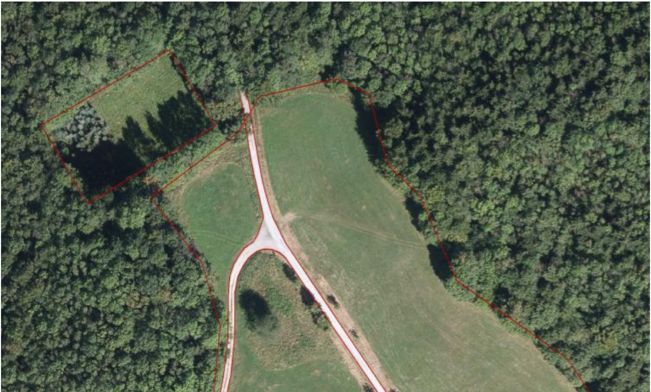
Obr. 2 Digitálna účelová mapa vyhotovená stereofotogrametrickým vyhodnotením
