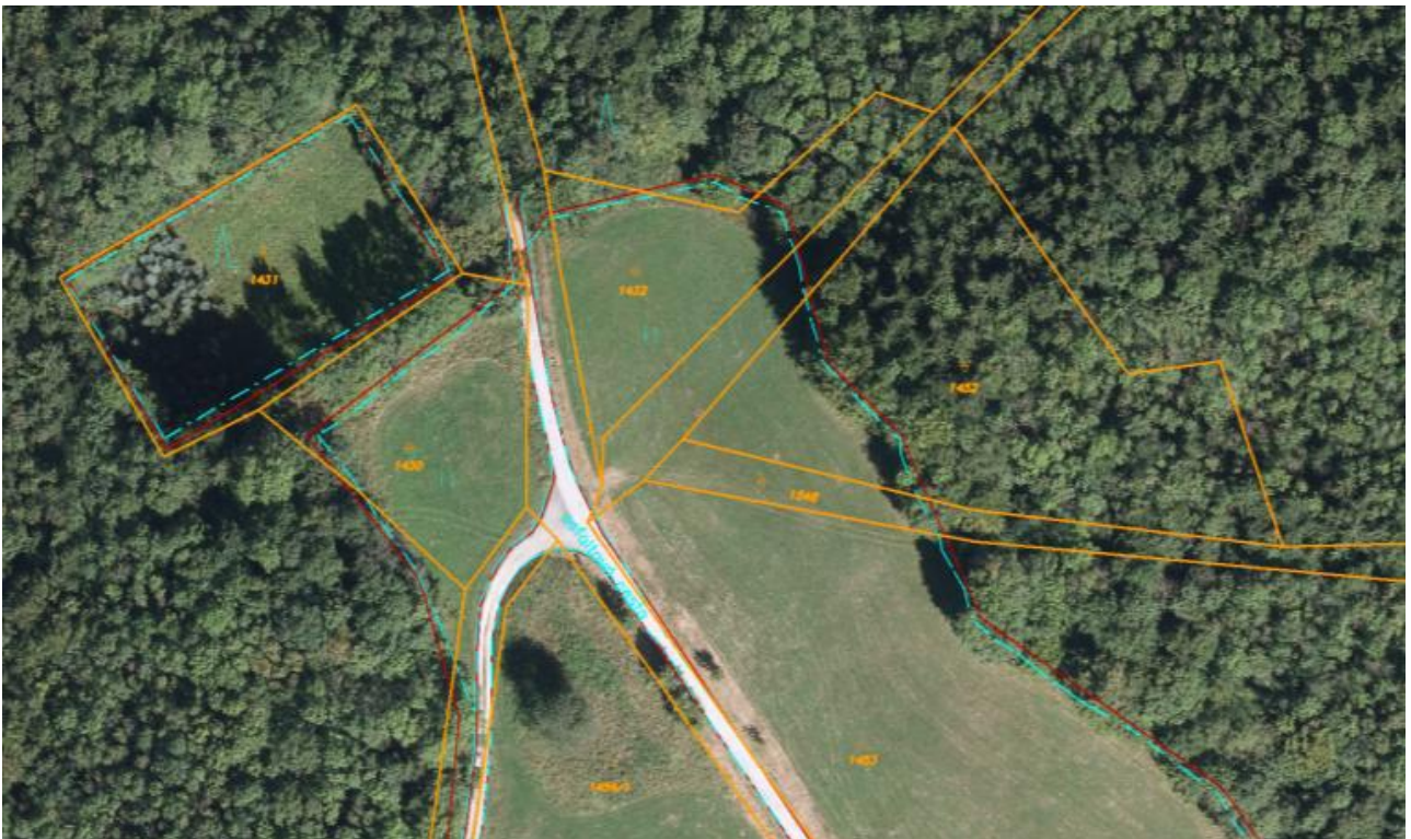
Obr. 3 Zobrazenie stereoskopického vyhodnotenia (červená farba) vyhodnotenie pomocou ortofotosnímký (modrá farba) žltá stav z katastrálnej mapy na podklade ortofotosnímký.
