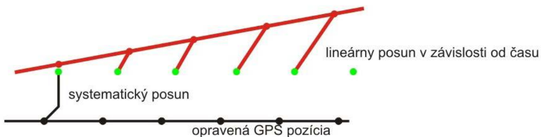
Obr. 2 Systematické chyby v určení projekčných centier snímok (INPHO, 2012)
