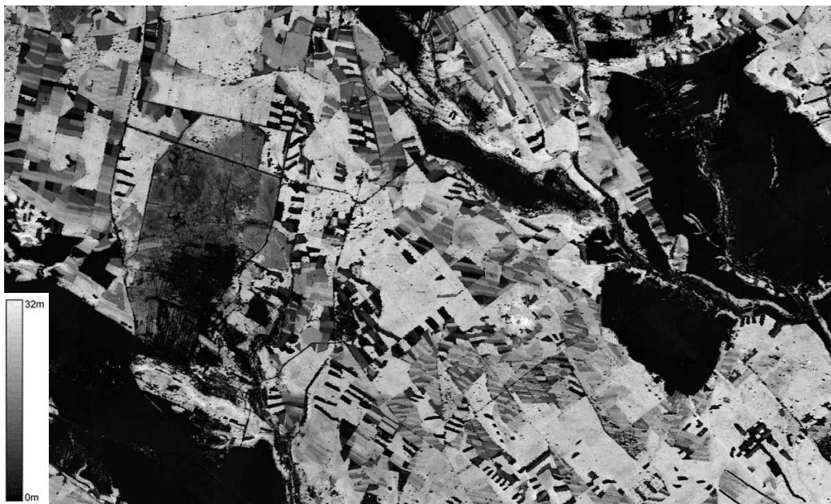
Obr. 3. Rastrový nDSM s hodnotami výšek porostů ve stupních šedi
