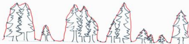
Obr. 2. Princip konstrukce normalizovaného digitálního modelu povrchu z leteckých snímků
