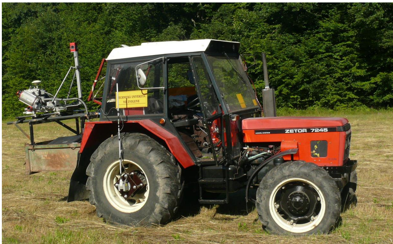
Obr.1 Mobilný mapovací systém Riegl VMX-250-CS6 umiestnený na plošinu pripevnenú na UKT typu Zetor Horal 7245
