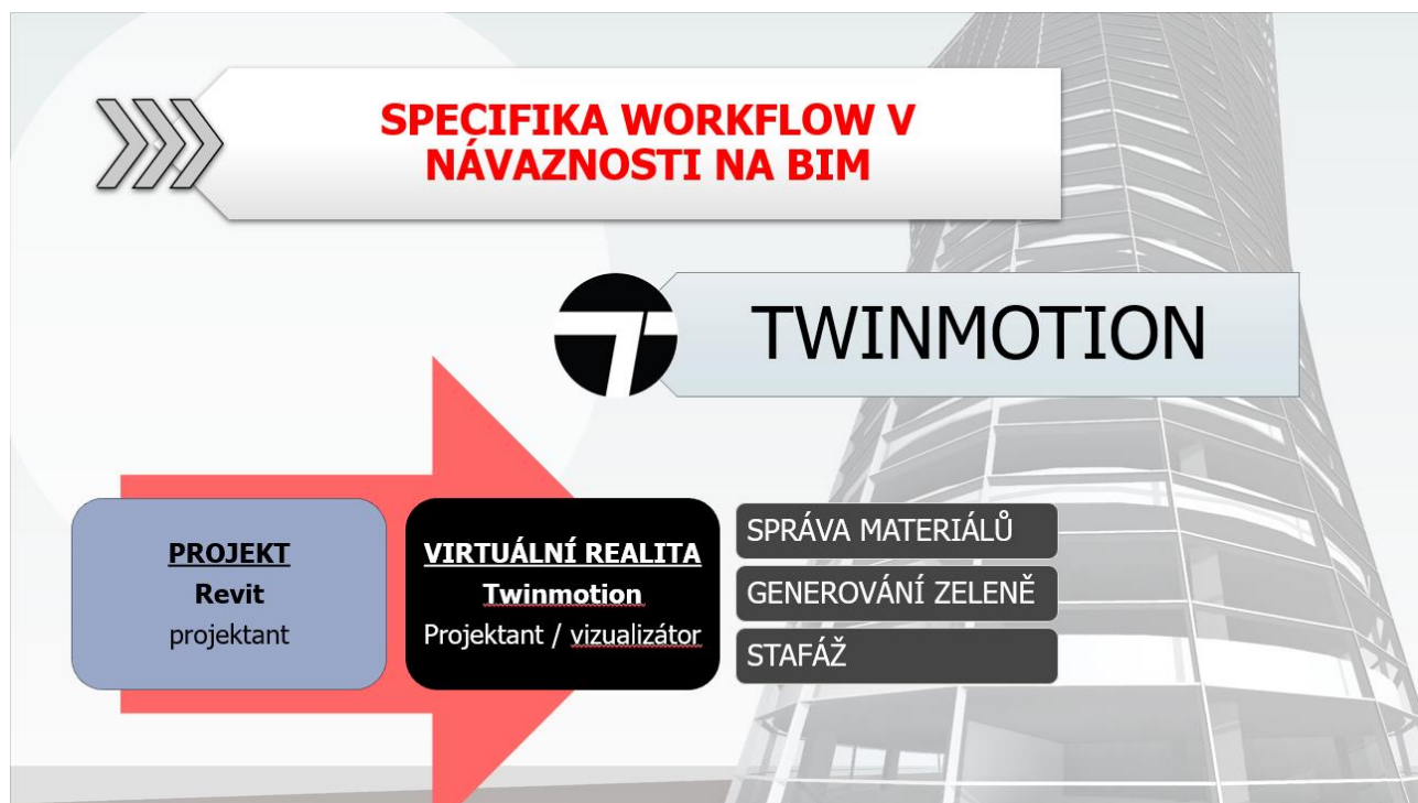
Obr. 6 schéma navázání VR na BIM v softwaru Twinmotion
