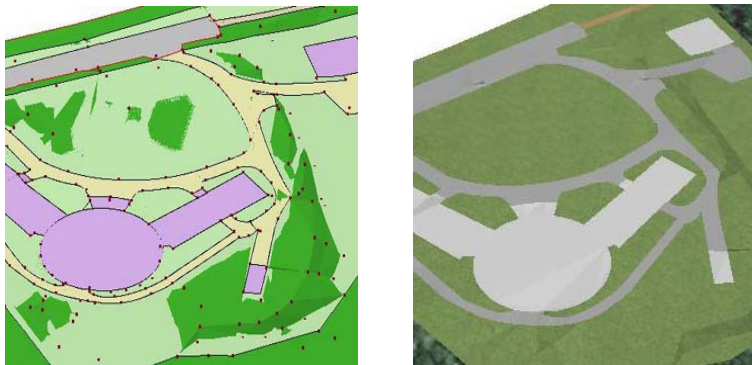
Obrázek 4 - "utopená" polygonová vrstva v TINu (vlevo), TIN s texturami podle hodnot tag (vpravo)
