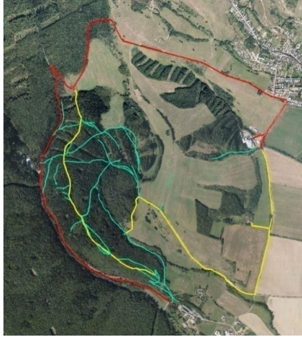
Obr.4. Cestná sieť identifikovaná z dát ALS Obr.5. Cestná sieť identifikovaná z dát LMS
