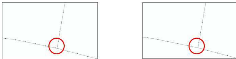
Obr. 1. Rozdíl v rozložení bodů po převedení dat z liniových na bodové v závislosti na použití liniových vrstev spojených funkcí „Merge“.
